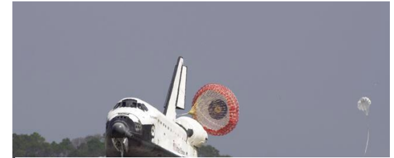
Pilt 5. NASA Kosmoselennuk Shuttle, mis erineb tavalennukist välimuselt vaid põhjakatte materjali poolest, mis ei lase lennukil atmosfääri sisenedes põlema süttida. Pildi autoriõigused: NASA
