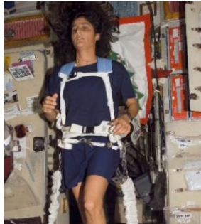
Pilt 1 Rahvusvahelises kosmosejaamas kasutatav jooksulint, kuhu astronaut kinnitatakse traksidega. Traksid on vajalikud, sest muidu hõljuks astronaut jooksulindilt minema. Pildi autoriõigused: NASA
