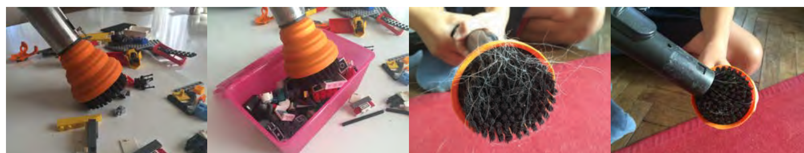
kuna lehter on silikoonist siis tõmbab õhk ta toru külge kinni ja otsikule pole vaja eraldi kinnitust leiutada
